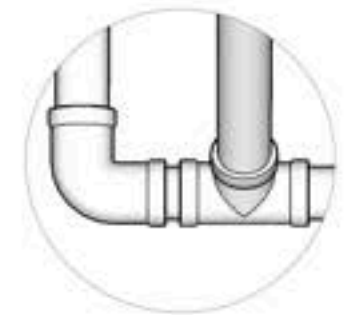
AMPLIAÇÃO TRAVE 3 CONEXÃO TUBOS DE PVC ESCALA: 1:7
