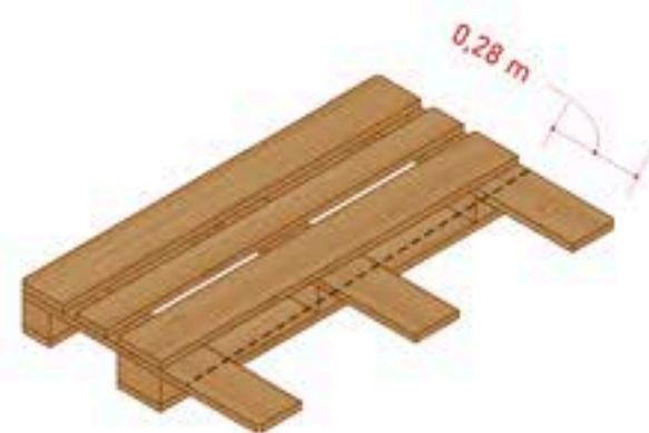
2- INDICAÇÃO COM MEDIDA DAS PARTES A SERRAR (FRENTE DO ENCOSTO) ESCALA 1:20
