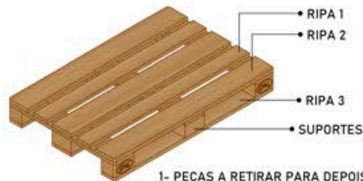
1- PEÇAS A RETIRAR PARA DEPOIS REAPROVEITAR (OS SUPORTES A RETIRAR SERÃO OS TRÊS A FRENTE) ESCALA 1:20
