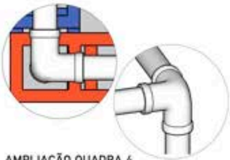
AMPLIAÇÃO QUADRA 4 CONEXÃO TUBOS PVC ESCALA 1:7
