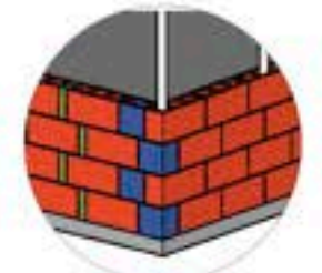
AMPLIAÇÃO QUADRA 1 ASSENTAMENTO DOS BLOCOS ESCALA 1:7
