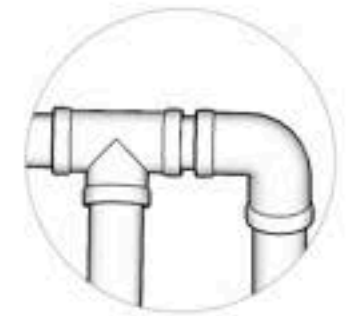
AMPLIAÇÃO TRAVE 1 CONEXÃO TUBOS DE PVC ESCALA: 1:7
